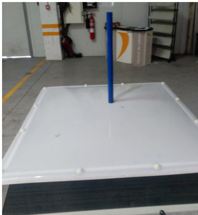
A.II-1: Ensayo impacto cuerpo duro
