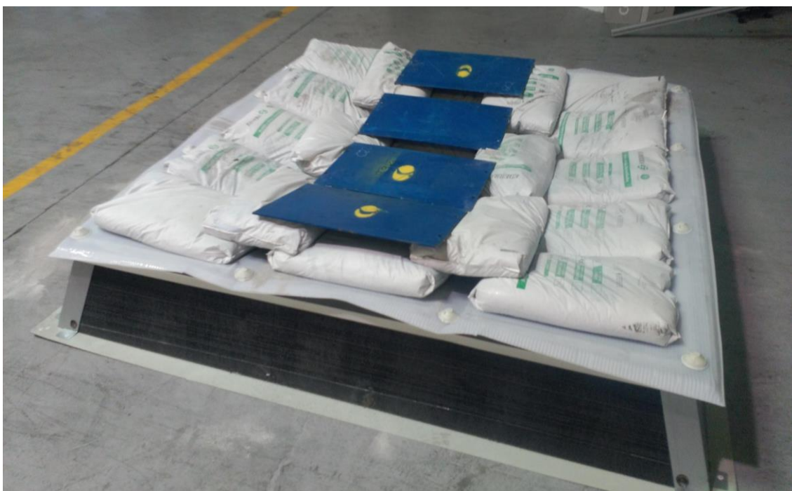
A.II-11: Ensayo de resistencia a las cargas hacia abajo
