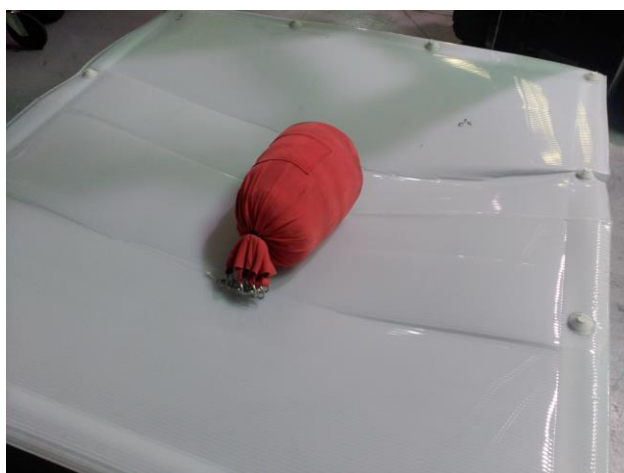
A.II-3: Ensayo impacto cuerpo blando (SB1200) sobre cúpula
