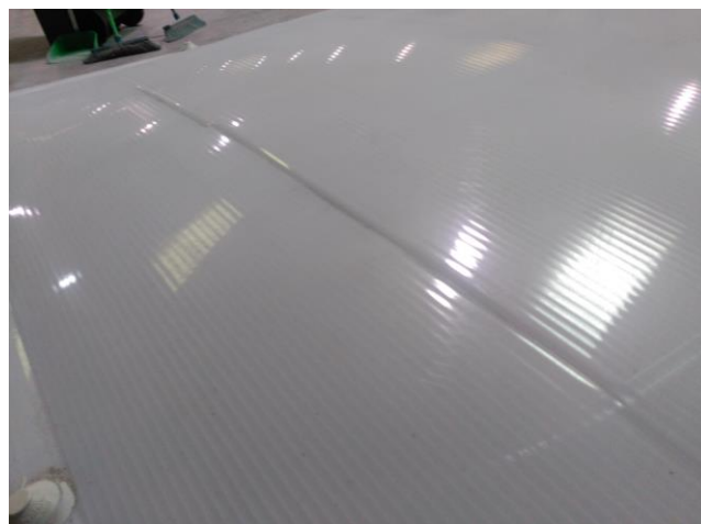
A.II-12: Resultado ensayo de resistencia a las cargas hacia abajo
