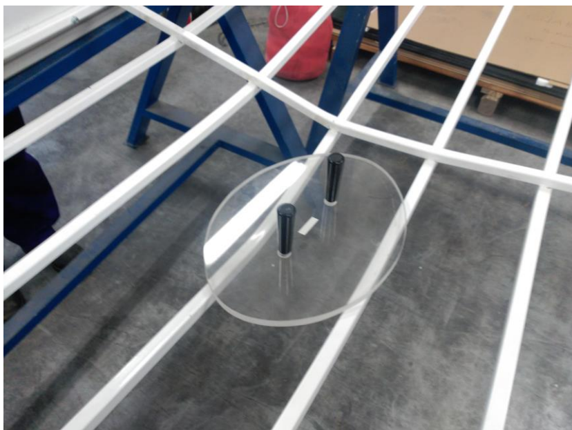
A.II-6: Resultado ensayo impacto cuerpo blando (SB1200) sobre reja de seguridad. 2000x2000 mm 2
