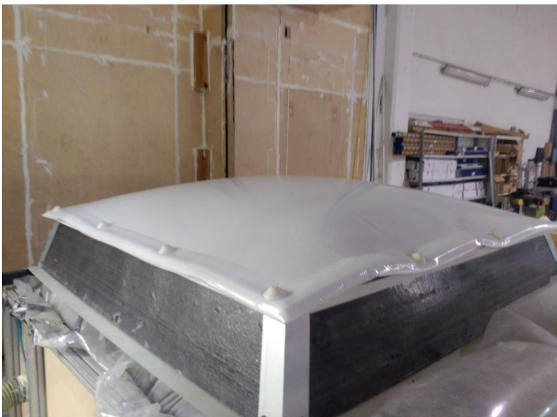
A.II-9: Ensayo de resistencia a las cargas hacia arriba
