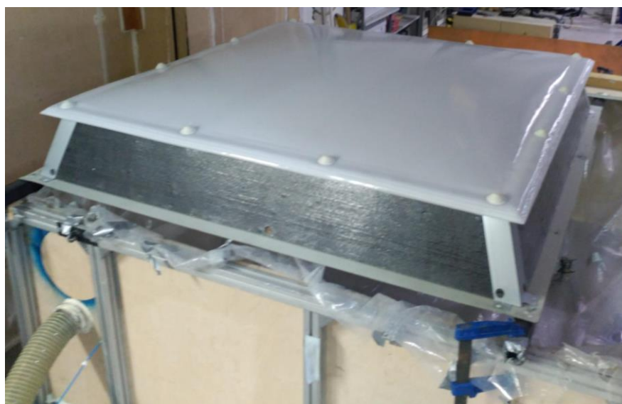
A.II-10: Resultado ensayo de resistencia a las cargas hacia arriba
