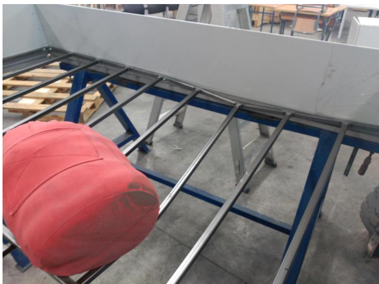
A.II-7: Ensayo impacto cuerpo blando (SB1200) sobre reja de seguridad. 3000x2000 mm 2
