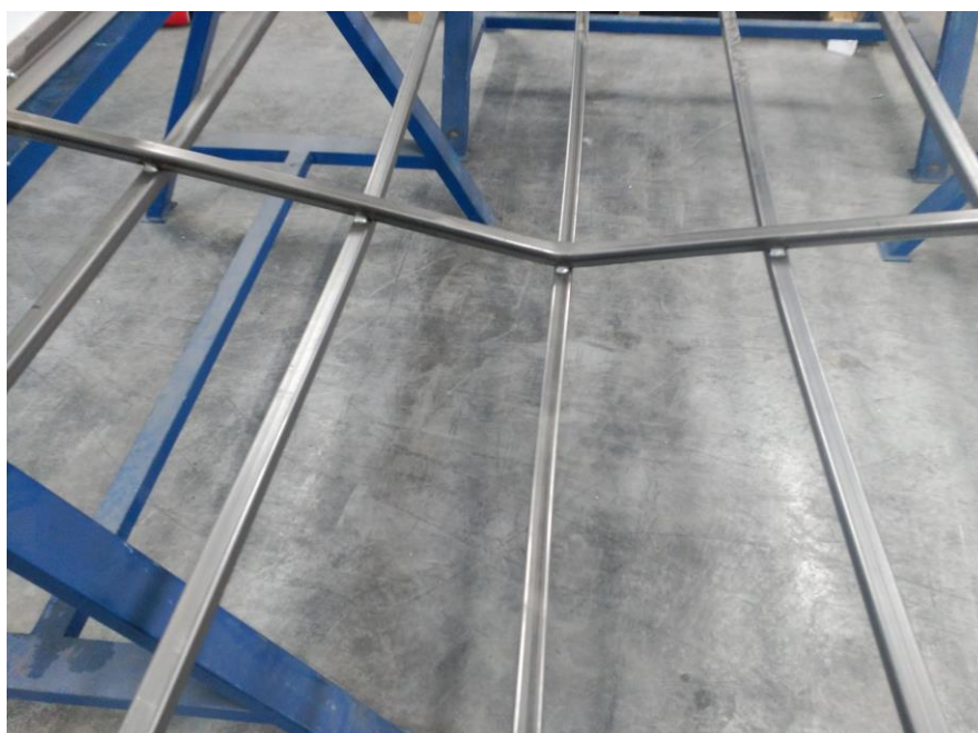
A.II-7: Ensayo impacto cuerpo blando (SB1200) sobre reja de seguridad. 3000x2000 mm 2
